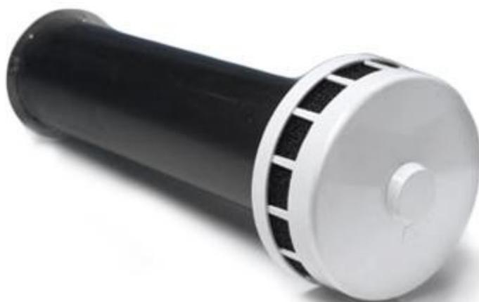
Можно сказать, что КПВ-125 представляет собой вариант модернизированной форточкой. Наружная решетка с сеткой задерживает листву, тополиный пух, насекомых. Теплошумоизоляция предотвращает "расползание" холода в толще стены и снижает уличный шум. Заслонка в оголовке клапана регулирует количество поступающего воздуха.
